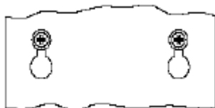
Obr.4 – šrouby zašroubujte tak, aby mezi šroubem a zdí zůstala mezera 2 – 3 mm.
