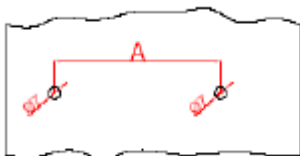
Obr. 1 – do zdi vyvrtejte 2 otvory o průměru 7 mm a hloubky 40 mm, rozteč A, v závislosti na typu lednice
